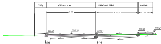
CHARAKTERISTICKÝ PŘÍČNÝ REZ Č.2 KOMUNIKACE A ZPEVNĚNÉ PLOCHY
